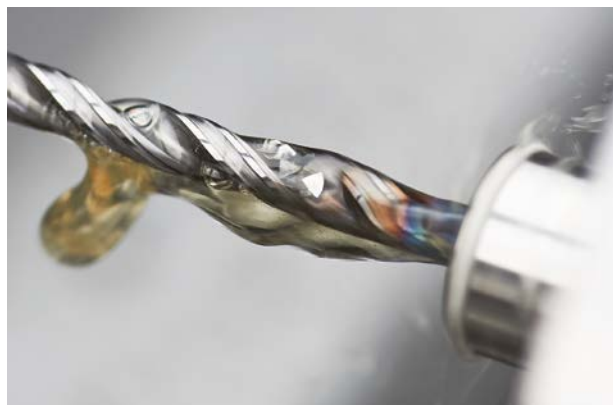
Perçage profond à l'aide de forets à arrosage interne. Les copeaux sont brisés et évacués vers le haut par l'hélice du foret, ce qui évite le bourrage.
