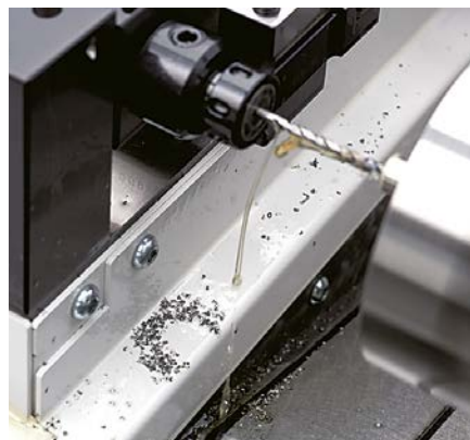
Perçage profond à l'aide de forets à arrosage interne. Les copeaux sont brisés et évacués vers le haut par l'hélice du foret, ce qui évite le bourrage.
